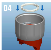
4.- Colocar junta en la posición indicada
